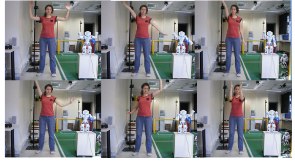
Şekil 4. Robotun insan eğitmenle beraber kol hareketlerini tekrar etmesi
