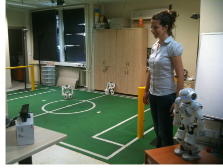
Şekil 1. İnsan eğitmenden hareketlerin öğrenilebilmesi için Nao robot ve Kinect algılayıcısından kurulan deney düzenegi
